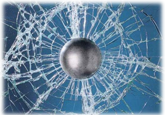
Abb: ESG Glasbruch
