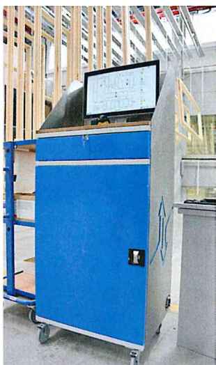
Der Leitrechner befindet sich in einem mobilen Terminal und wird von einer Batterie gespeist.
