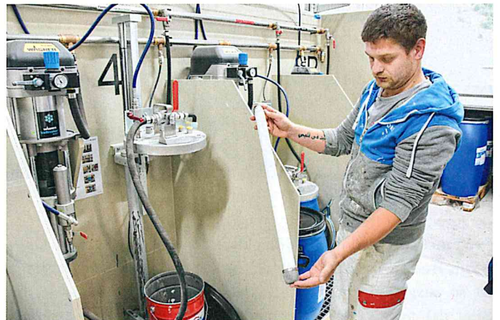
Ansaugrohre aus Polypropylen erlauben ein schnelles Auswechseln der Farbgebinde.
