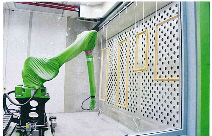
Die 7-Achs-Roboter ermöglichen eine gleichmässige Schichtdicke und können auch Lasuren applizieren.
