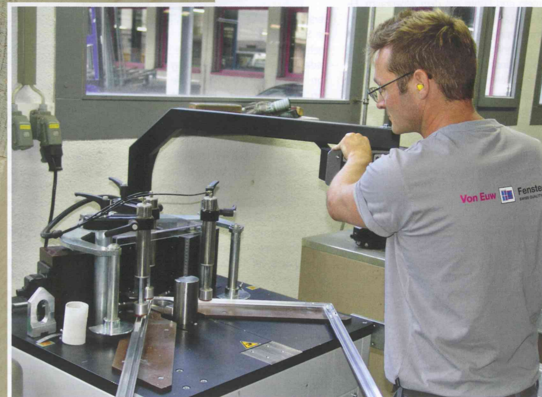
Die Alu-Profile für die Holz-Alu-Fenster werden im Haus zugeschnitten, in den Ecken verstanzt und einbrennlackiert
