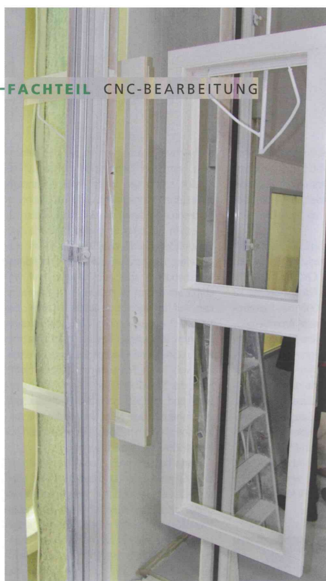
Die in der Flutanlage grundierten Teile laufen hängend in den Vertikal-Spritzroboter ein. Der dunkle, schmale Streifen ist der Scanner, der dem Roboter die Steuerdaten liefert
