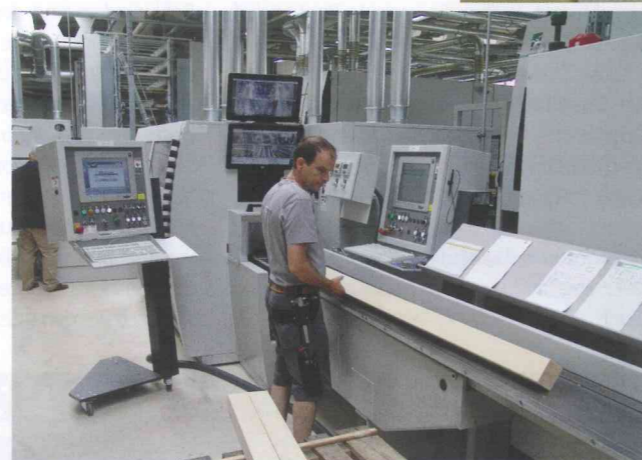
Produktionsstart: Einlauf beim Vierseitenhobler „Powermat 1200“, dessen Tisch Rohkanteln bis zu 5 m Länge zuführen kann
