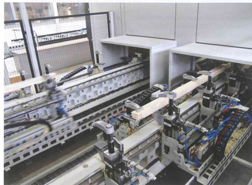
Rechts: Die automatische Doppelkappsäge längt auf Fertigmaß ab, danach werden die Kanteln auf den Zangentischen fixiert. Links: Blick auf die beiden unabhängig voneinander laufenden Produktionsstränge
