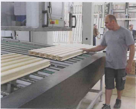
Auslauf der Conturex-Anlage mit abschließender Qualitätskontrolle: Hier werden die CNC-bearbeiteten Teile nochmals in Augenschein genommen.
