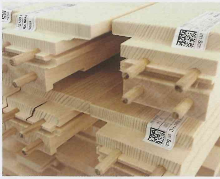
/ Bei großen Friesbreiten werden auf der Conturex gedübelte Konter-Eckverbindungen hergestellt. Sämtliche Teile erhalten ein Barcode-Etikett.
