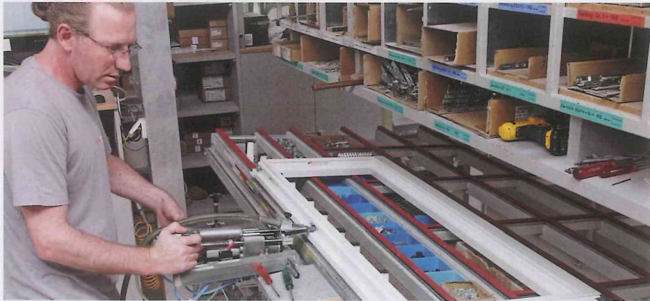
/ Die Beschlagsmontage erfolgt bei von Euw komplett papierlos. Ein Bildschirm am Montagetisch liefert dem Mitarbeiter dazu sämtliche erforderlichen Informationen. Die Arbeitsplätze sind ergonomisch optimiert, Beschläge, Zubehörteile und Werkzeuge sind jederzeit im schnellen Zugriff.
