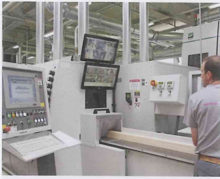
In der Conturex sorgen sechs Portale, sieben Haupt- und drei Universalspindeln, ein Mehrspindelbohrkopf und Ritzaggregat für Präzisionsbearbeitung.
